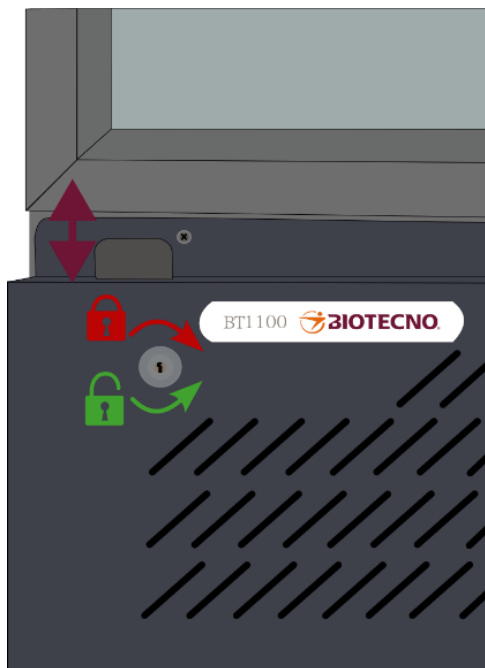
Figura 21-Sistema de fechamento da porta com chave.
