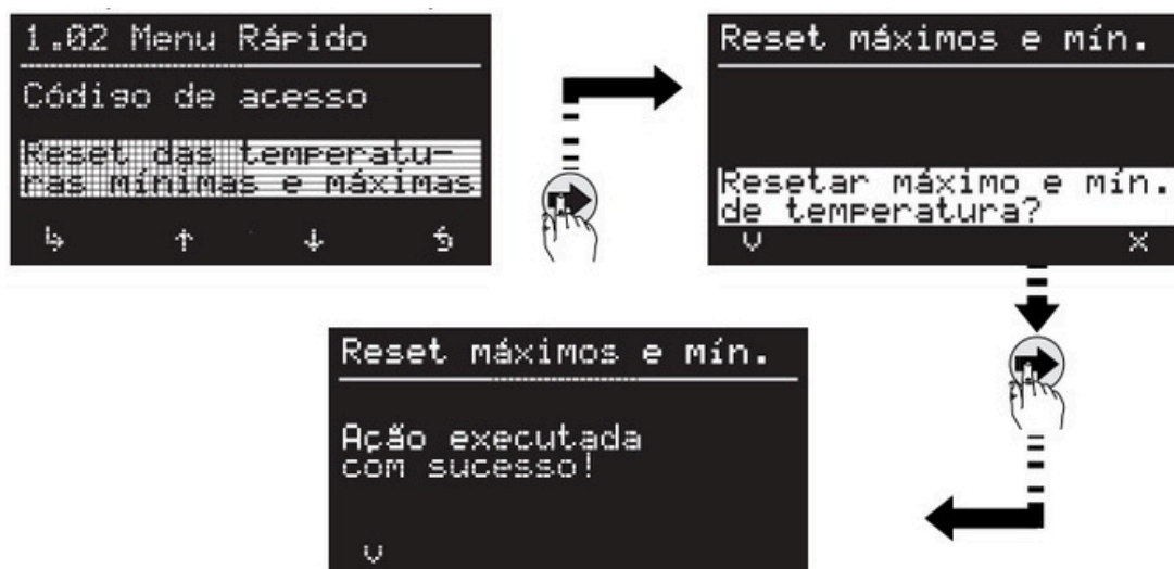
Figura 12-Reset de mínima e máxima.
